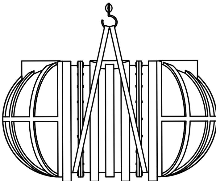
*Схема допустимого способа строповки изделия. В случае увеличения длины емкости, пропорционально увеличивается охват строп.*
